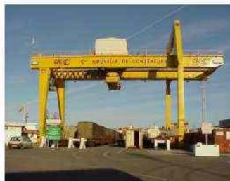
La technique multimodale : un portique de manutention circulant sur des rails fixés sur deux chemins de roulement en béton. Aucun tassement n'est admis sous les chemins de roulement (risque de déraillement du portique)
